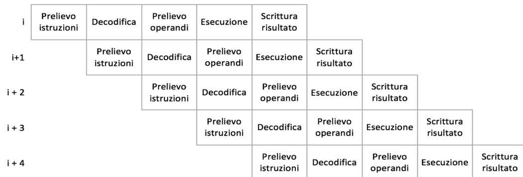
Figura 9.2: Diagramma temporale dell'utilizzo dei circuiti con una pipeline
