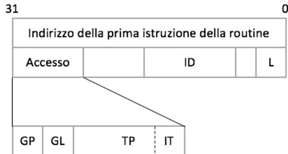
Figura 5.1: Struttura di un gate di interruzione
