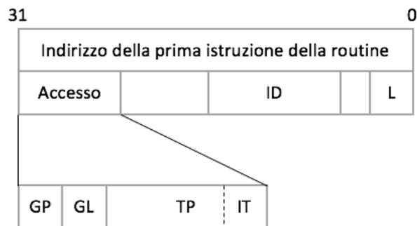
Figura A.1: Struttura di un gate di interruzione
